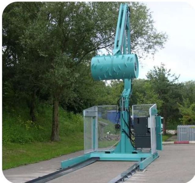
Abb. 12-5: Neuer Walzenverdichter auf der Deponie Achern-Maiwald
